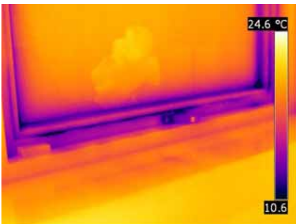
Doppelverglasung undicht in den Rahmen eingesetzt
