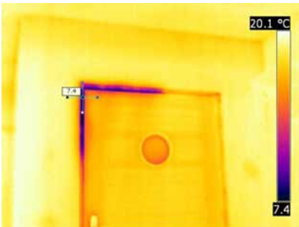
Hauseingangstür: Undichte Schließung oben links (hohe Undichtigkeit)
