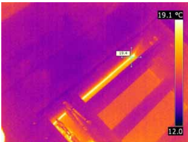
Dachbodenluke von oben: Undichte Schließung an den Scharnieren
