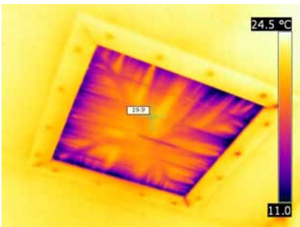
Dachbodenluke sehr undicht
