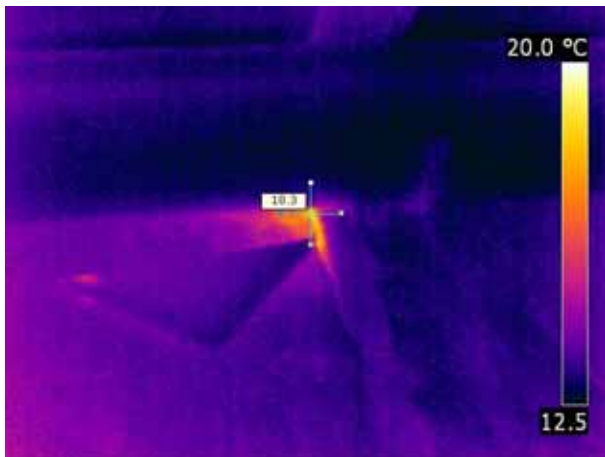
Dachboden: Dämmung undicht – erwärmte Raumlufte aus dem OG strömt ein. Sparrenfeld Dachbodenluke links linke Seite
