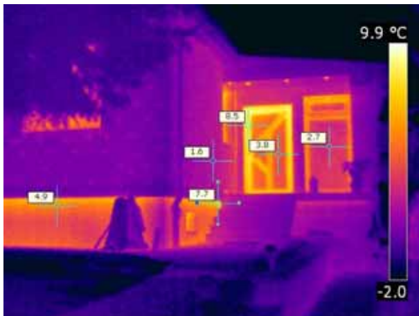
Wärmeverluste über das Sockelmauerwerk
