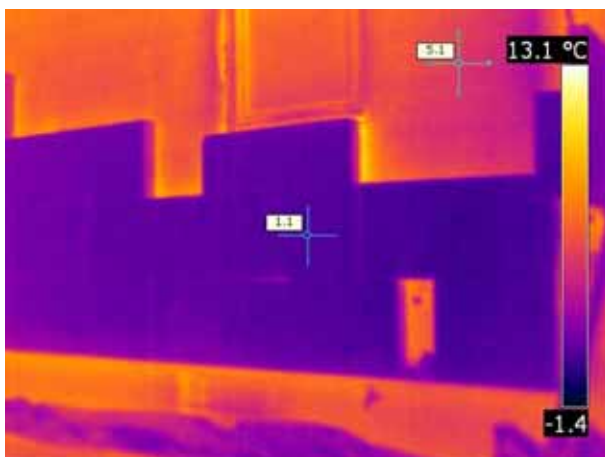
Vergleich gedämmt – ungedämmt. Aufnahme ist während der Dämmarbeiten am frühen Morgen entstanden
