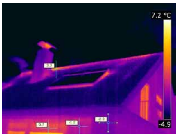
Wärmeverluste über undichtes Dach und undichten Einbau der Dachfenster
