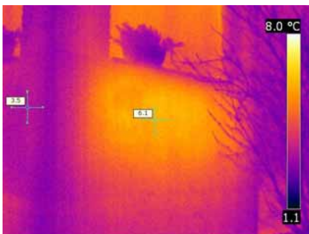
Wärmeverluste über Heizkörpernische, Lage des Heizkörpers ist erkennbar
